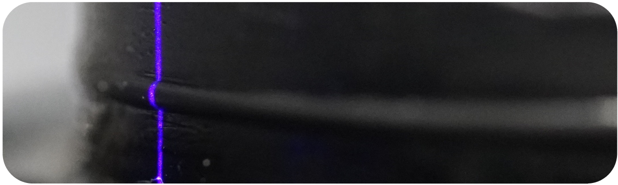
Abb. 6: Leicht überfüllter Rheometerspalt mit schwarzem Polymer, dessen Meniskus vom Laser erfasst wird; obere und untere Platte wurden schwarz geprimert.
